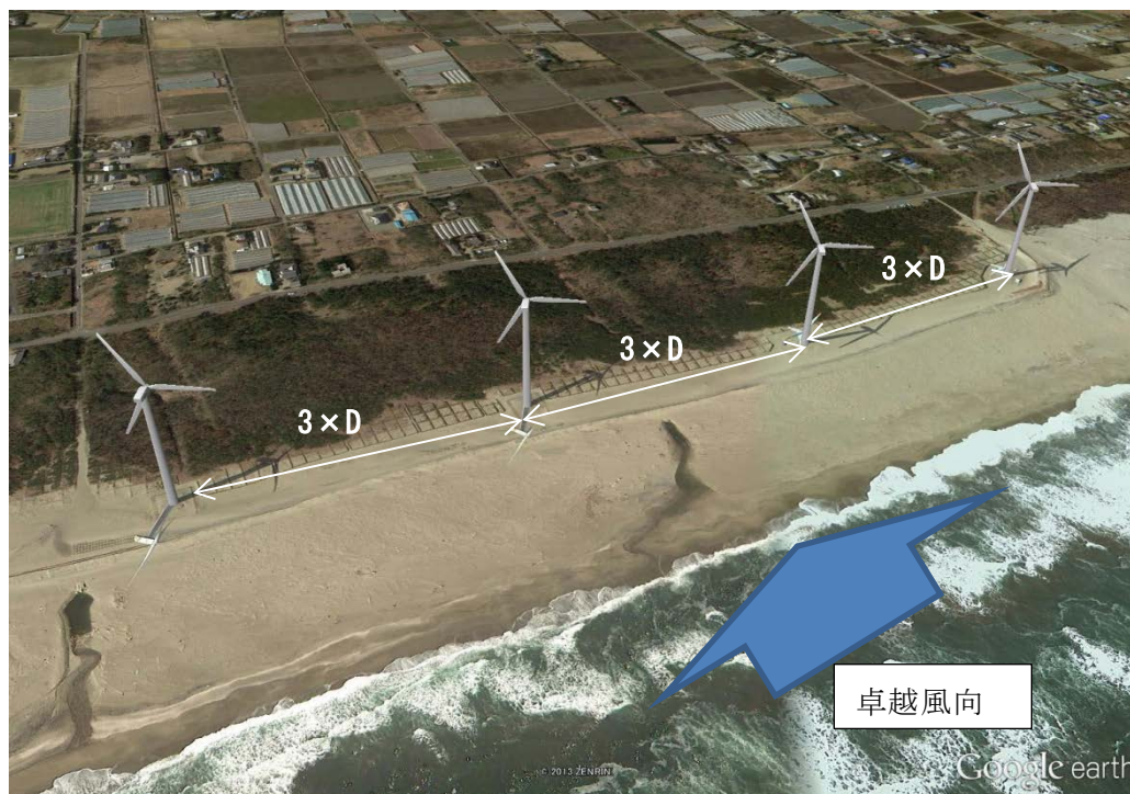
図 2.5-10 風車を複数基設置した場合の配置例
