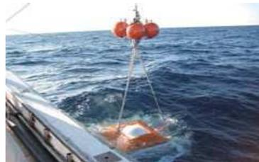
TRBM とは、トロール・レジスタント・ボトム・マウントの略で、主に底曳網漁業区域に流速計を設置する際に使用する土台です。台形型の土台は底曳網に引っ掛かることなく、転倒や流出のリスクが軽減されます。回収時には船上からの音響装置によって切り離し装置が作動し、内蔵されたロープとともに流速計が浮上します。流速計回収後は、ロープをたぐって TRBM を引き上げます。空中重量は 400kg 程度ですので、投入と回収の際にはウィンチとデリックを装備した船舶が必要です。標準設置深度は最大 200m です (出典：沿岸海洋調査 (株) HP)。
