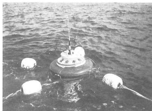
写真-1 海上送信局の外観と設置状況
